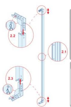
il disegno e le istruzioni sono riferite al box con apertura a destra. Se si desidera l'apertura a sinistra, basta invertire la posizione dei due profili laterali, in modo da avere il profilo con i piccoli fori per il fissaggio della placchetpiccoli fori ta magnetica (Fig. 2.1) sul lato sinistro.
